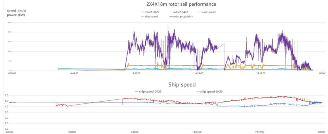
图 4.5 旋筒风帆开启关闭与船舶航速变化的对比图（4月22日-23日）
